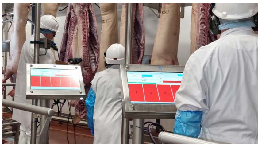
Détection des odeurs SANMALO sur chaîne à 700 porcs par heure
