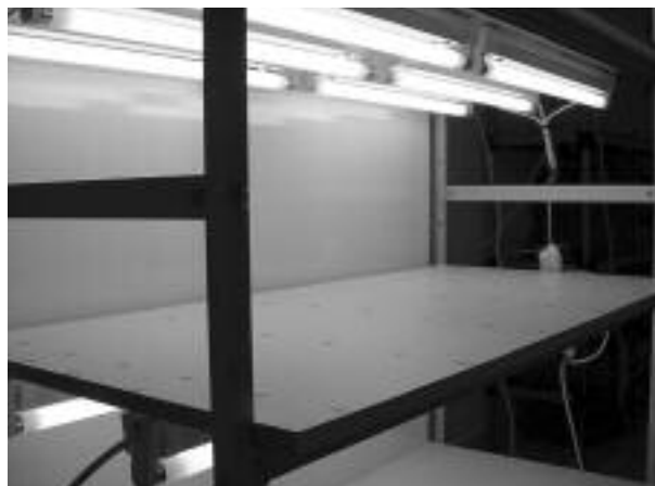
PHOTO 1 : test de deux configurations (étage haut : 6 tubes de 60 cm ; étage bas : 4 tubes de 60 cm)
