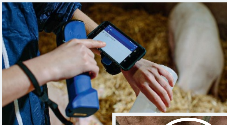
▲ LA SONDE TRANSMET DIRECTEMENT LES IMAGES au smartphone positionné sur le poignet de l'opérateur. Si besoin, elles peuvent être enregistrées.
