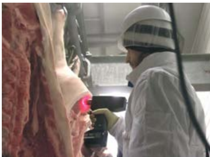
Mesure de spectroscopie Raman sur carcasse déviée en fin de chaîne d'abattage (délai post mortem = 30 minutes)
