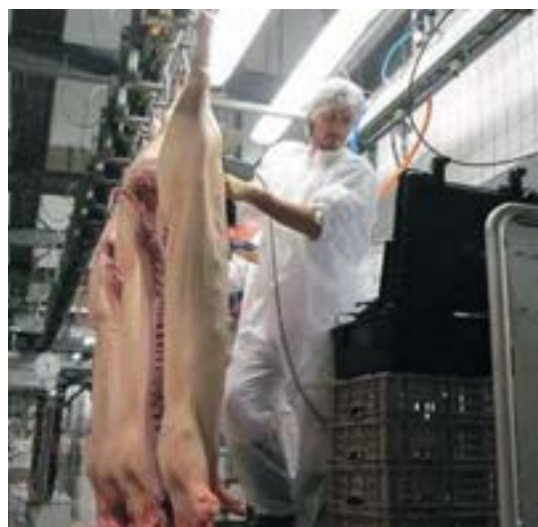
Mesure de spectroscopie Raman sur carcasse déviée en fin de chaîne d'abattage (délai post mortem = 30 minutes)
