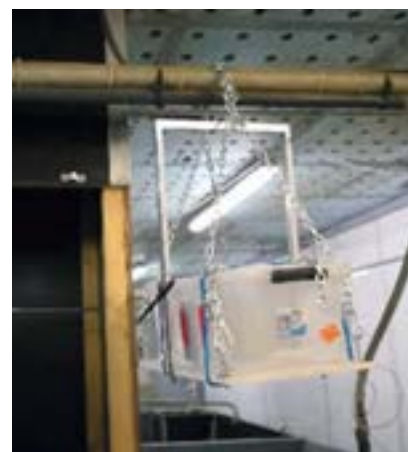
Test de la position de mesures de particules à l'aide de compteurs optiques
