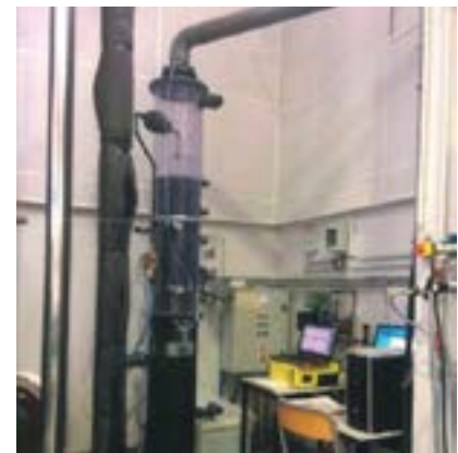
Colonne de lavage d'air en conditions maîtrisées (source : IMT Atlantique).
