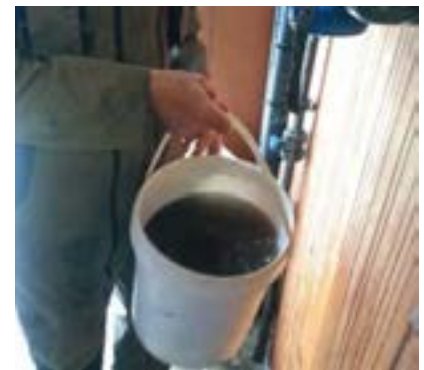
Eau prélevée en post-sevrage et présentant un excès de manganèse. Le risque de dépôt de biofilm et d'usure prématurée des équipements (pompe, abreuvoirs ; compteur...) est accru.
