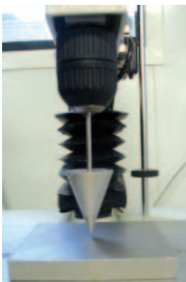
Cône utilisé pour les mesures de pénétrométrie
