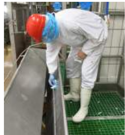
Prélèvement sur la goulotte abats blancs après nettoyage désinfection.
