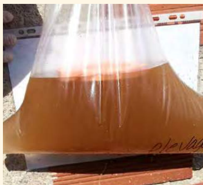
Couleur orange de l'eau indiquant la présence d'un biofilm riche en fer
