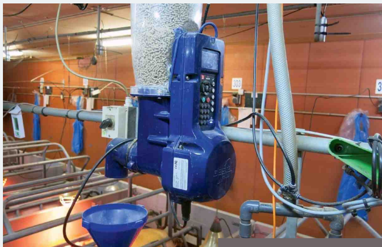
▲ UN DOSEUR EST RELIÉ À UNE VIS SANS FIN pour faire tomber l'aliment en petites quantités dans l'auge.
