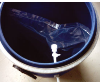
Photo 3 : Sac en tedlar dans un fût de prélèvement d'air en vue de l'analyse d'odeurs
