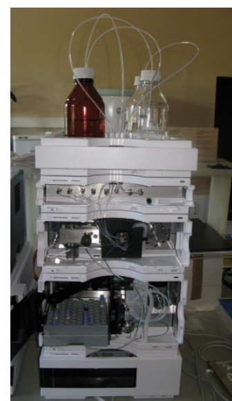
Laboratoire d'analyse des odeurs par méthode HPLC développé en collaboration IFIP-INRA
